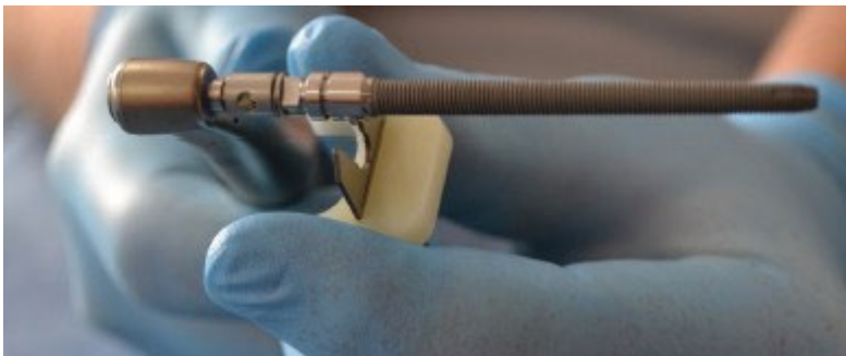
Figura 4: inserire lo strumento di posizionamento del manipo (I-CON-X) sul supporto della montatura e separare l'impianto dalla clip in titanio sul porta-impianti
