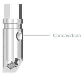
Figura 22: Ondulação no suporte de fixação.
