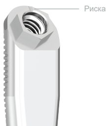
Рисунок 21: Риска в шестиграннике имплантата.
